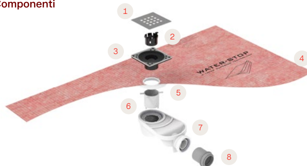
1. Griglia Evo / 2. Raccogliacapelli / 3. Corpo Evo / 4. Guaina Water-Stop / 5. Adattatore / 6. Corona Ruber / 7. Sifone Ruber / 8. Riduttore Ø 50/40 mm
